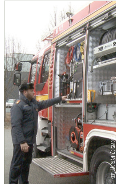
Az új tűzoltóautó málháza van, ami azt jelenti: minden tűzoltótechnikai felszerelést tartalmaz
